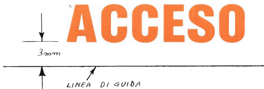
Fig. 4 - Se si usano lettere trasferibili a secco, si tracci anzitutto con una matita una leggera linea a 3 mm circa dal fondo delle lettere che si vogliono scrivere.
